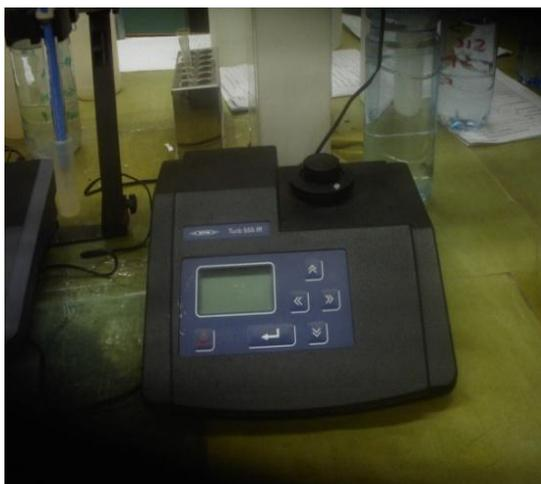
**Figure 3 :** Turbidimètre de laboratoire
