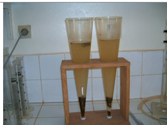
Photo V. 5: Essai de décantation par cône d'Imhoff
