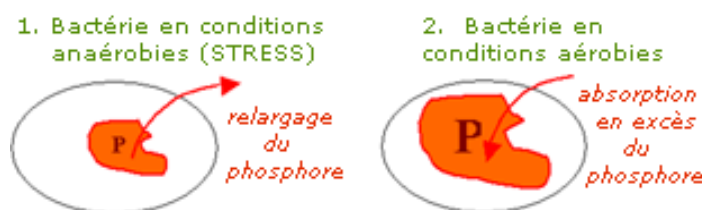
Figure II. 3 : Fonctionnement d'une bactérie déphosphatante en conditions aérobie et anaérobies. ( www.gls.fr/mémotech n°23)
