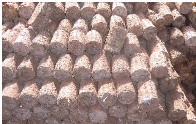
Figure 8: Bûchettes combustibles obtenues à partir des papiers/carton
