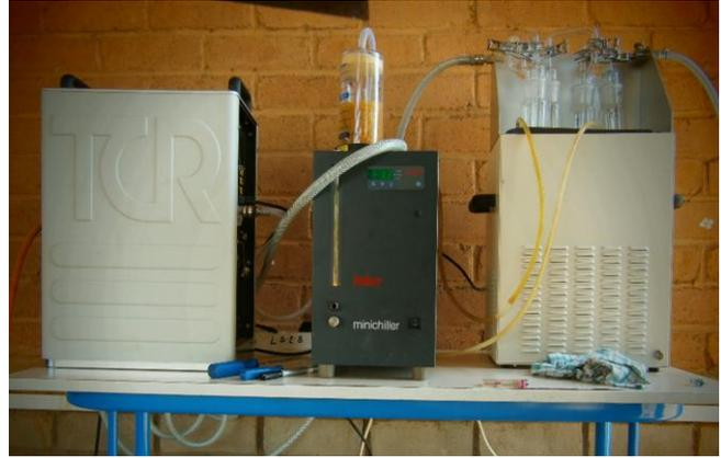
Figure 19 : Système de condensation et module de pompage
