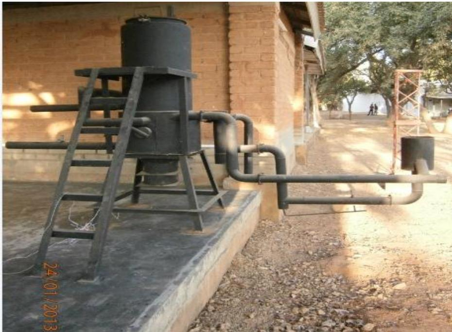
**Figure 10 :** Unité pilote de la gazéification vue de la plateforme LBEB 2IE (Photo 2ie)
