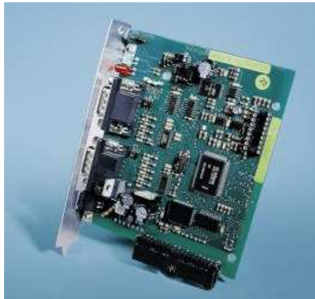
Figure 4: Carte interne d'un data-logger, copyright Fronius.
