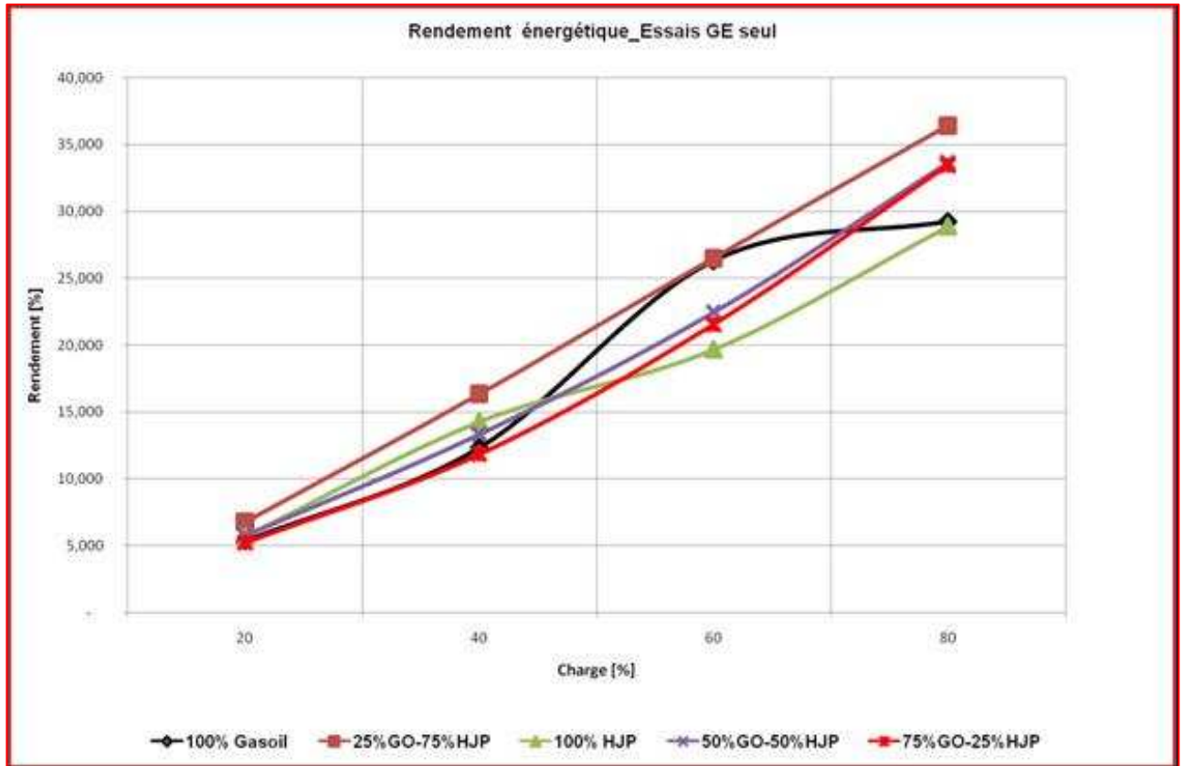
Figure 7. Rendement énergétique _ Essais GE seul [%]
