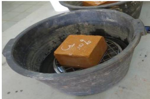
**Figure 8: Dispositif d'essai d'absorption capillaire**
