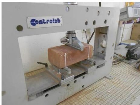
Figure 10: Essai de flexion
