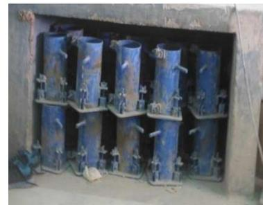
**Figure 12 : Eprouvettes cylindriques 16X32**
