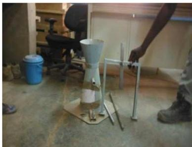
**Figure 11 : cône d'Abrams**
