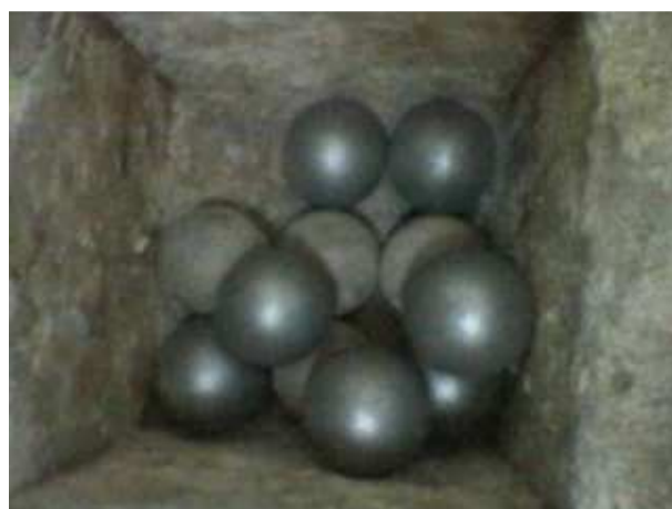
Figure 5 : Boulets de l'essai Los Angeles
