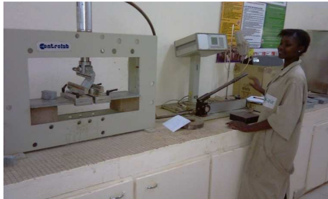
Figure 10 : Essai de résistance à la flexion à l'aide du portique universel
