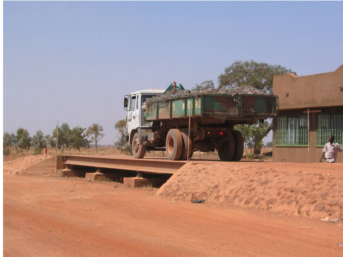
FIG. A.10 –: Peser du camion à l'entrée du CET.
