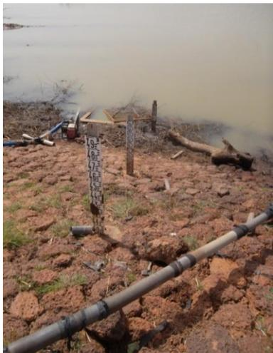
**Photo 2 : Echelle limnimétrique au niveau de la retenue de Kierma**
