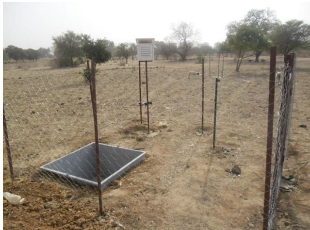
**Photo 5 : Abri météo clôturé avec le bac évaporateur**
