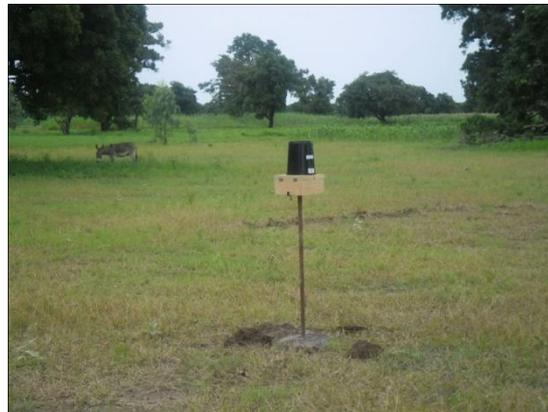
**Photo 4 : Pluviographe dans le bassin versant de Kierma**
