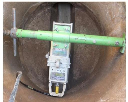
Figure 2: Installation du Flo-Dar dans un regard
