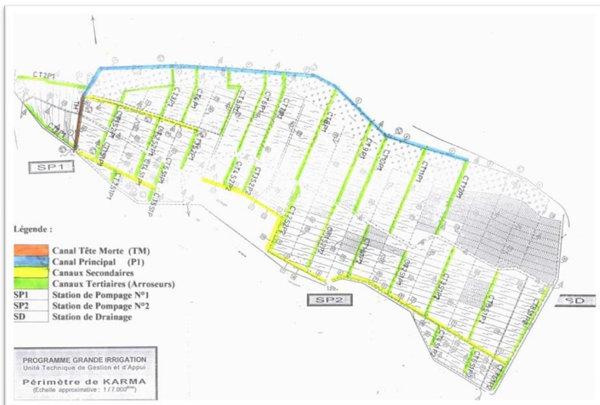
**Figure 2** : Plan du Réseau d'Irrigation Karma (source : UTGE /PGI)
