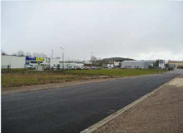
Photographie : 3 Une imperméabilisation du bassin versant de 10 % en plus entraine le doublement du débit pointe de crues
