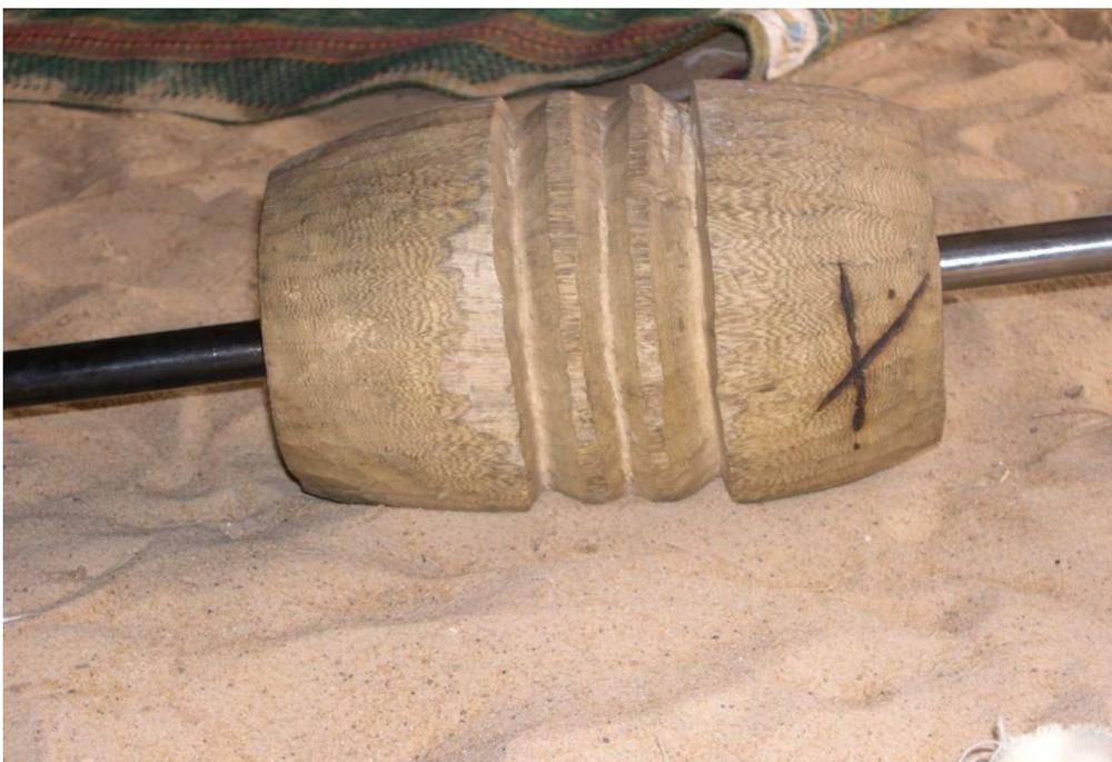
**PHOTO 5** : Poulie fabriquée avec du bois de *Calotropis procera*
