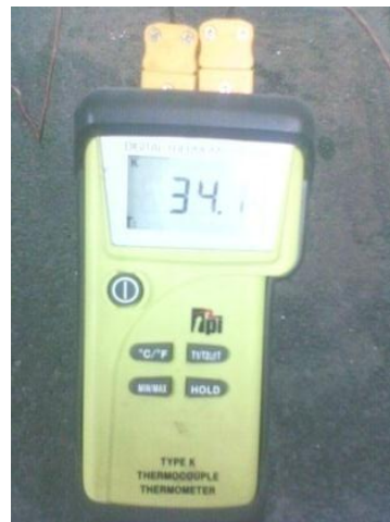
Photographie 9 : Thermocouple TPI 343, type K
