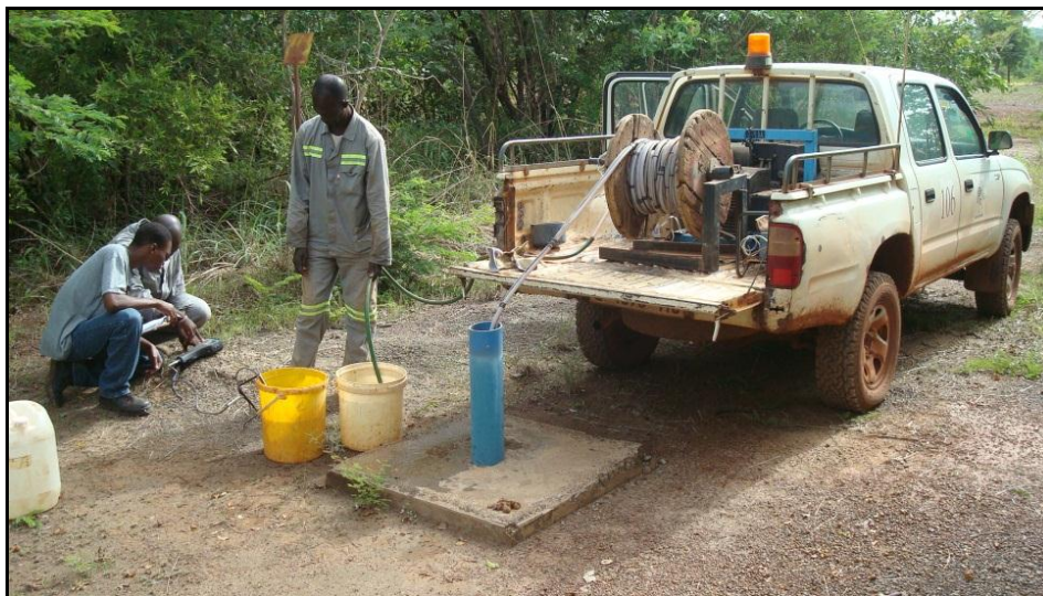
Photographie n°6 : Echantillonnage d'une nappe souterraine, (cliché A. KANTE, mine d'or de Morila, Juin 2011)
