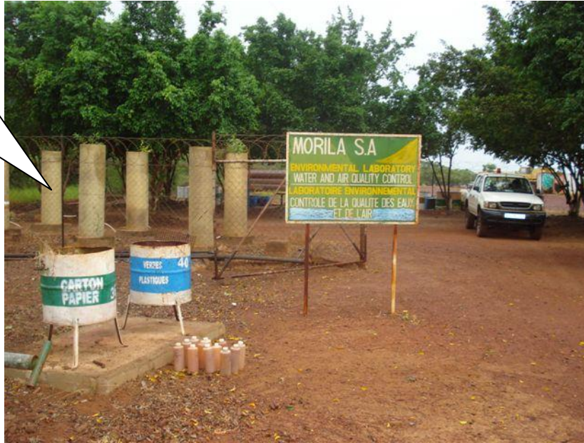
Photographie n° 7 : Des cellules colonnes pour l'évaluation du potentiel d'acidité des roches (cliché S. ILBOUDO, mine d'or de Morila, Septembre 2011)
