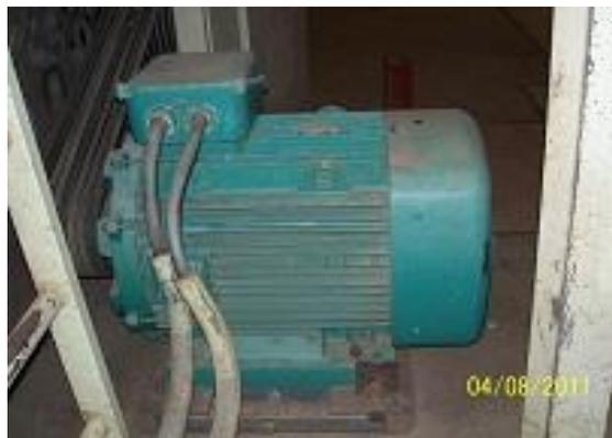
Figure 17 (Moteur électrique de 110 KW monté sur l'égreneuse)
