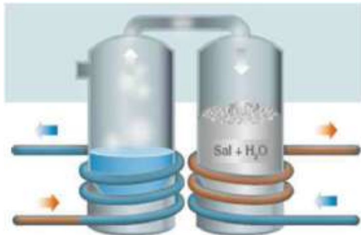
Figure 5: Absorption de la vapeur par les sels avec dégagement de chaleur
