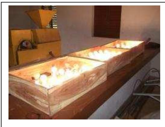
Image 7 : Banc de charge en fonctionnement
