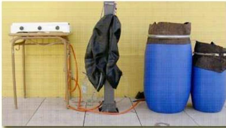
Digesteur de démonstration et application (digesteur en bidons PVC et à gazomètres séparés)
