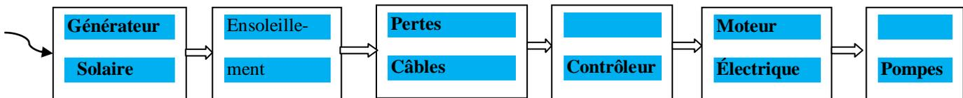
**Figure 7:** Schéma de la configuration du système de pompage d'eau pour arrosage des espaces verts.
