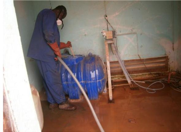
**Figure 17: Dosage approximatif de HTH**      **Figure 18: Agitation manuelle de la solution**
