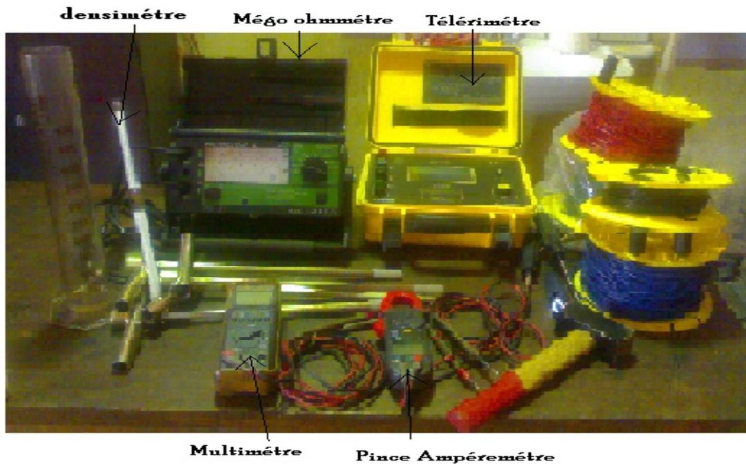
Figure 14 : Appareils de mesure
