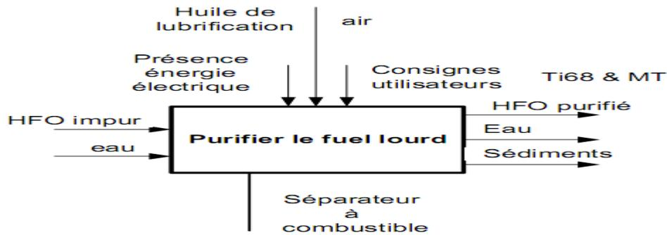
Figure 9 : Diagramme S.A.D.T du séparateur à HFO[14].
