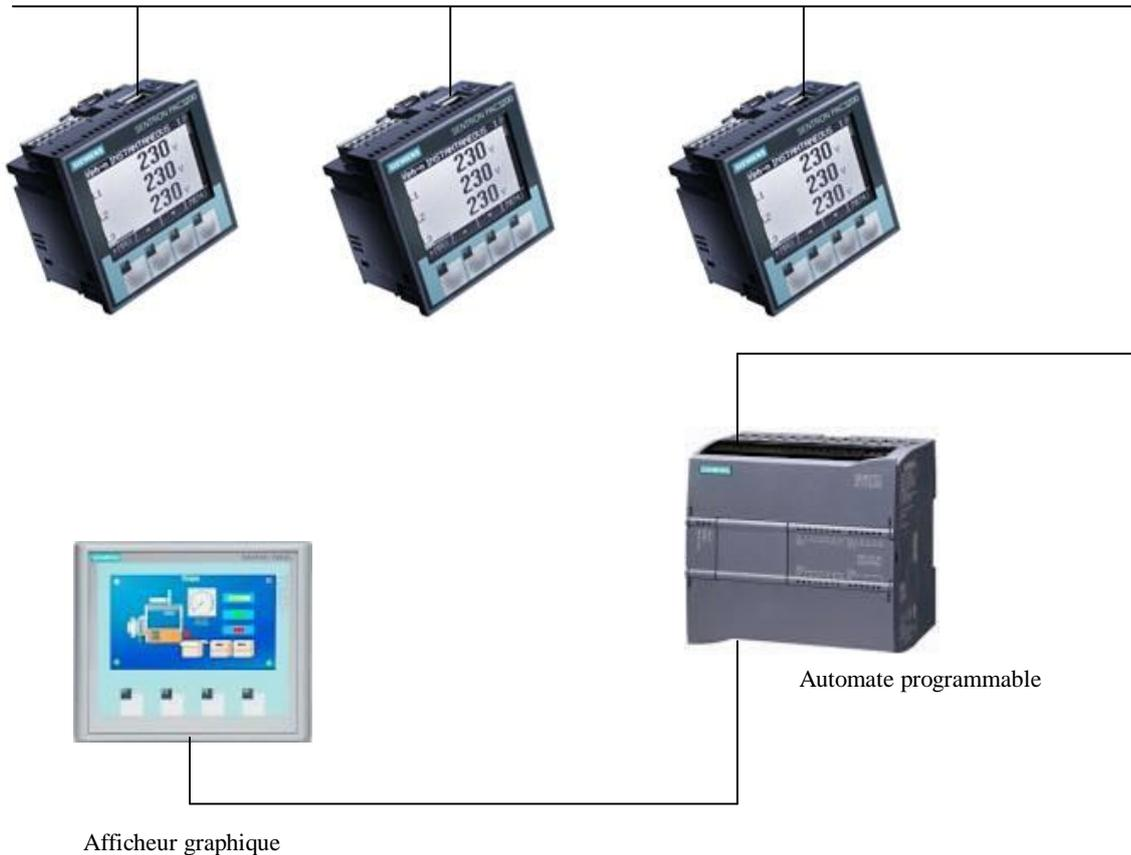
*Figure 8 : Schéma simplifié de montage d'une centrale de mesure*
