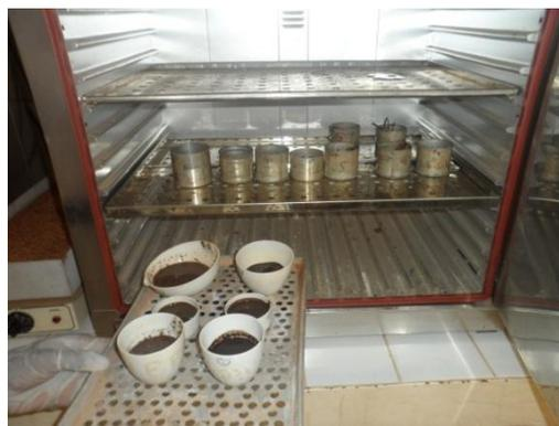
**Figure 9:** Mise d'échantillons à l'étuve
