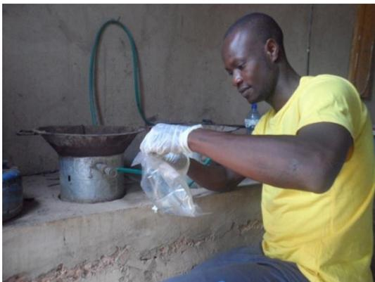
**Figure 10:** Prélèvement du biogaz
