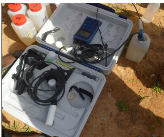
Figure 11: mesure des paramètres in situ par un multi paramètres Multi WTW 340i/SET
