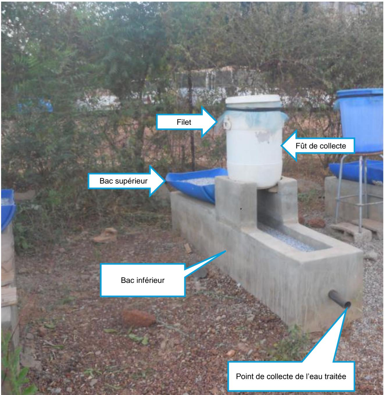
**Figure 6 :** Schéma montrant les différents composants des pilotes
