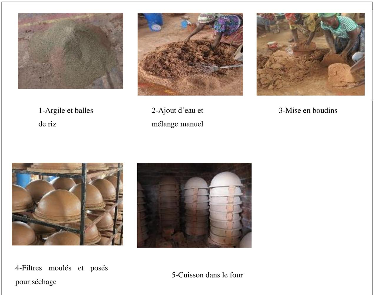
**Figure 8: Etapes de fabrication du filtre en céramique à PHW, Ghana.**
