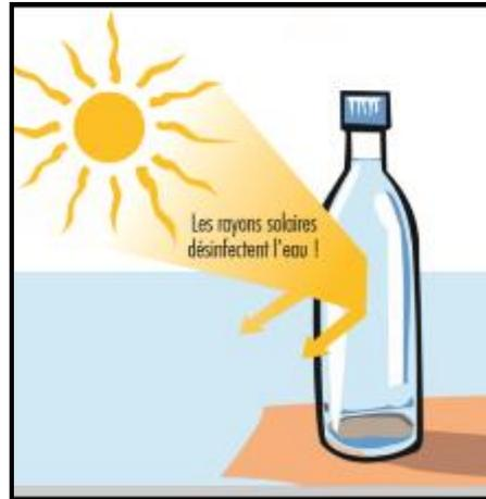
**Figure 4: Traitement de l'eau par désinfection solaire**
