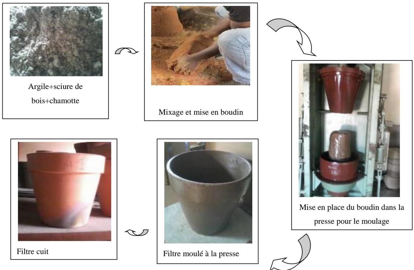
**Figure 7: Processus de fabrication des filtres en céramique**
