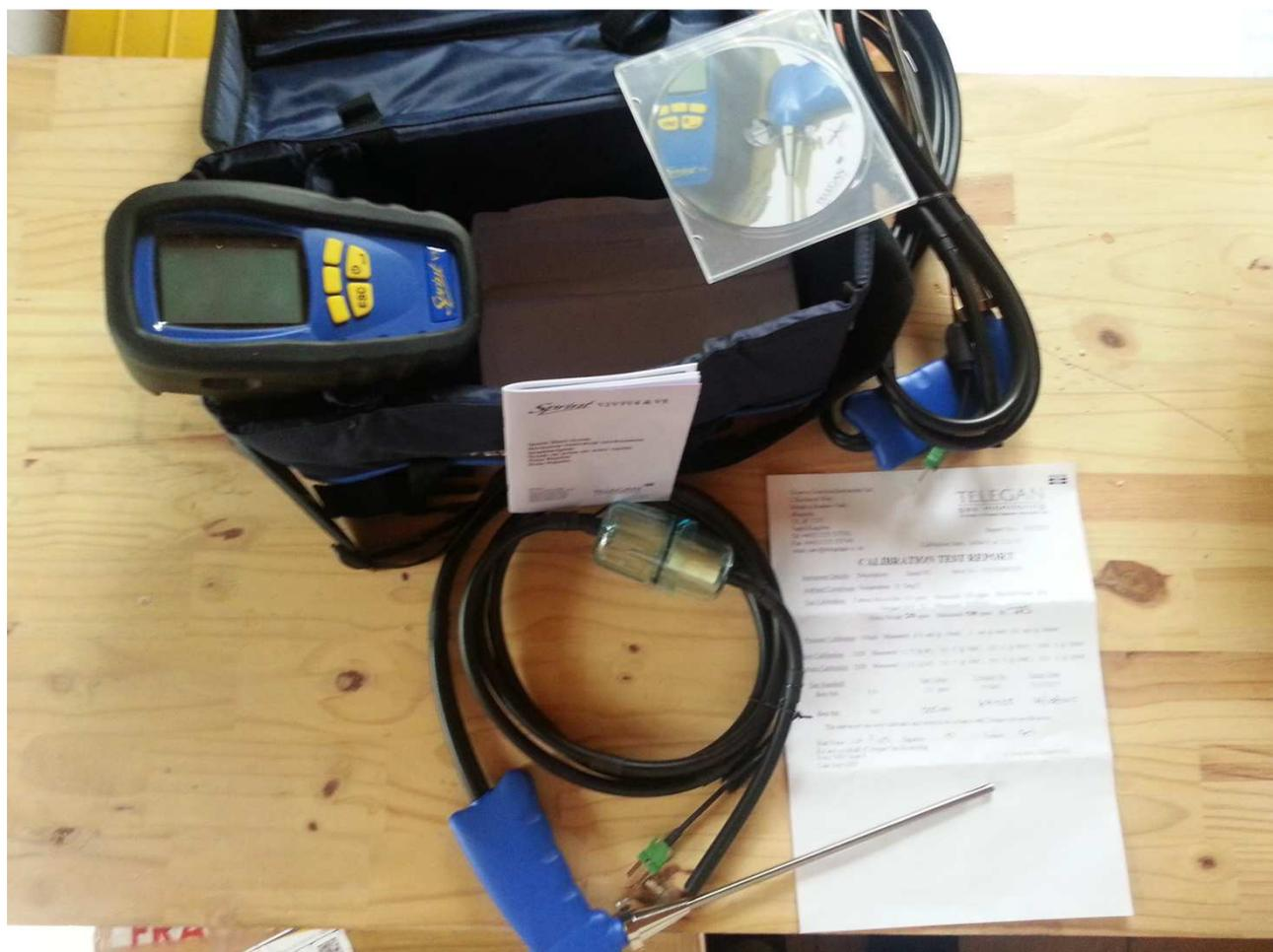
Figure 15 : Analyseur Sprint V4 à mesure d'O<sub>2</sub>, CO<sub>2</sub> et composés azotés volatils
