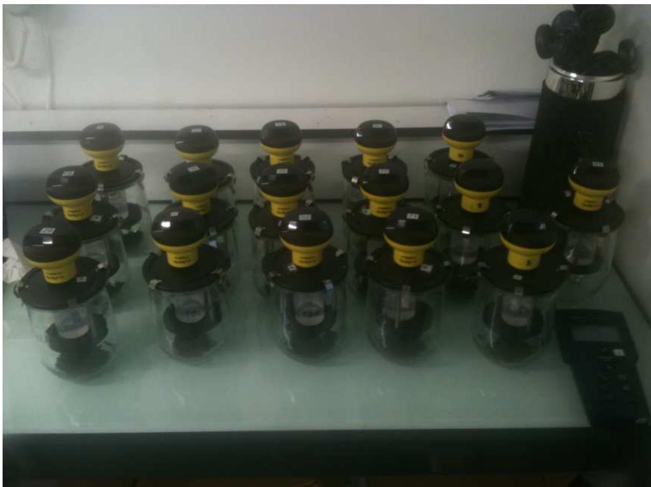
*Figure 14: Dispositif expérimental du test ARS.*
