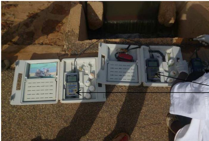
Appareil de mesure des paramètres physicochimiques (pH-mètre, oxymètre et conductimètre)
