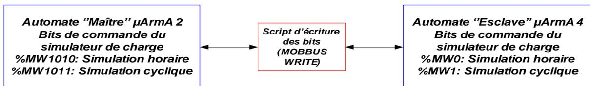
**Figure 26: Principe d'exécution du script d'écriture des bits de commande**
