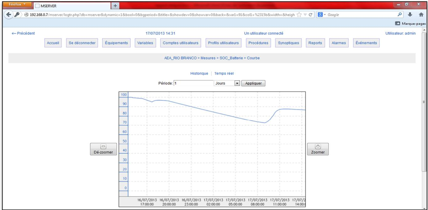
Figure 31: Courbe du SOC batterie visualisée par  $\mu$ Server pour le site de Rio Branco
