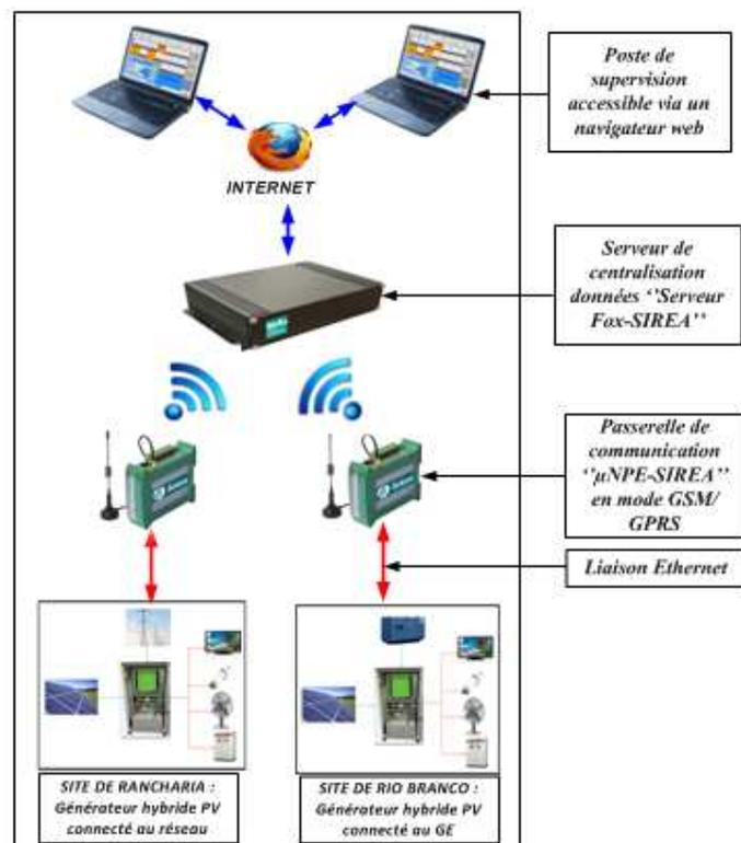
**Figure 27: Architecture globale du système de supervision**
