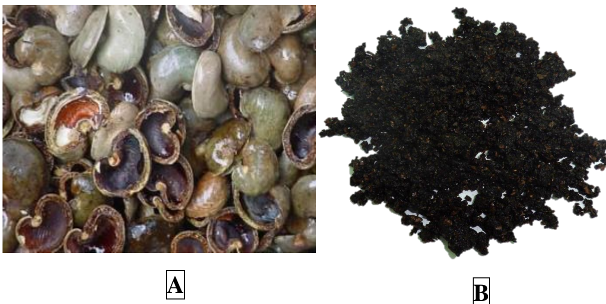
Figure 10: Echantillon de coques brutes ( A : coques entières (30,2093g) ; B : Coques broyées (épaisseur \leq 1 mm)
