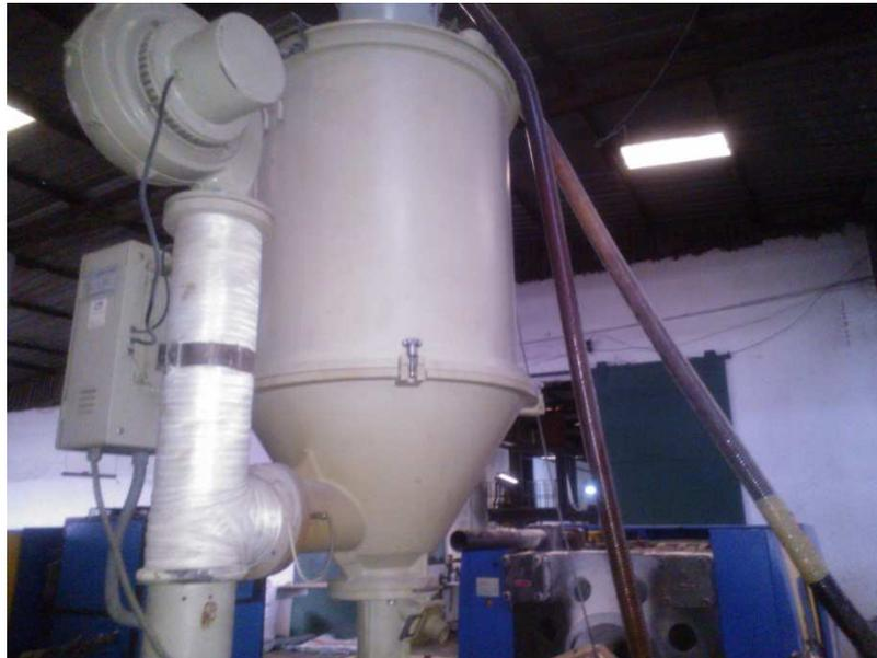
**Photo 3 : cuve de préchauffe du polymère a l'injection**
