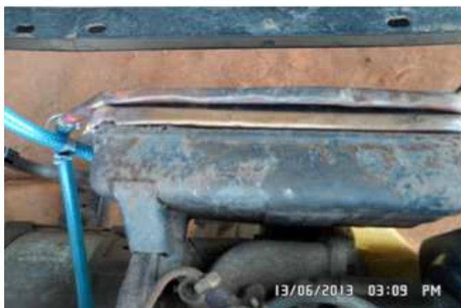
Figure 2-12 : Système de préchauffage.
