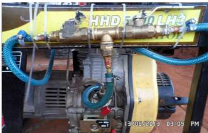
Figure 2-13 : Système de basculement.
