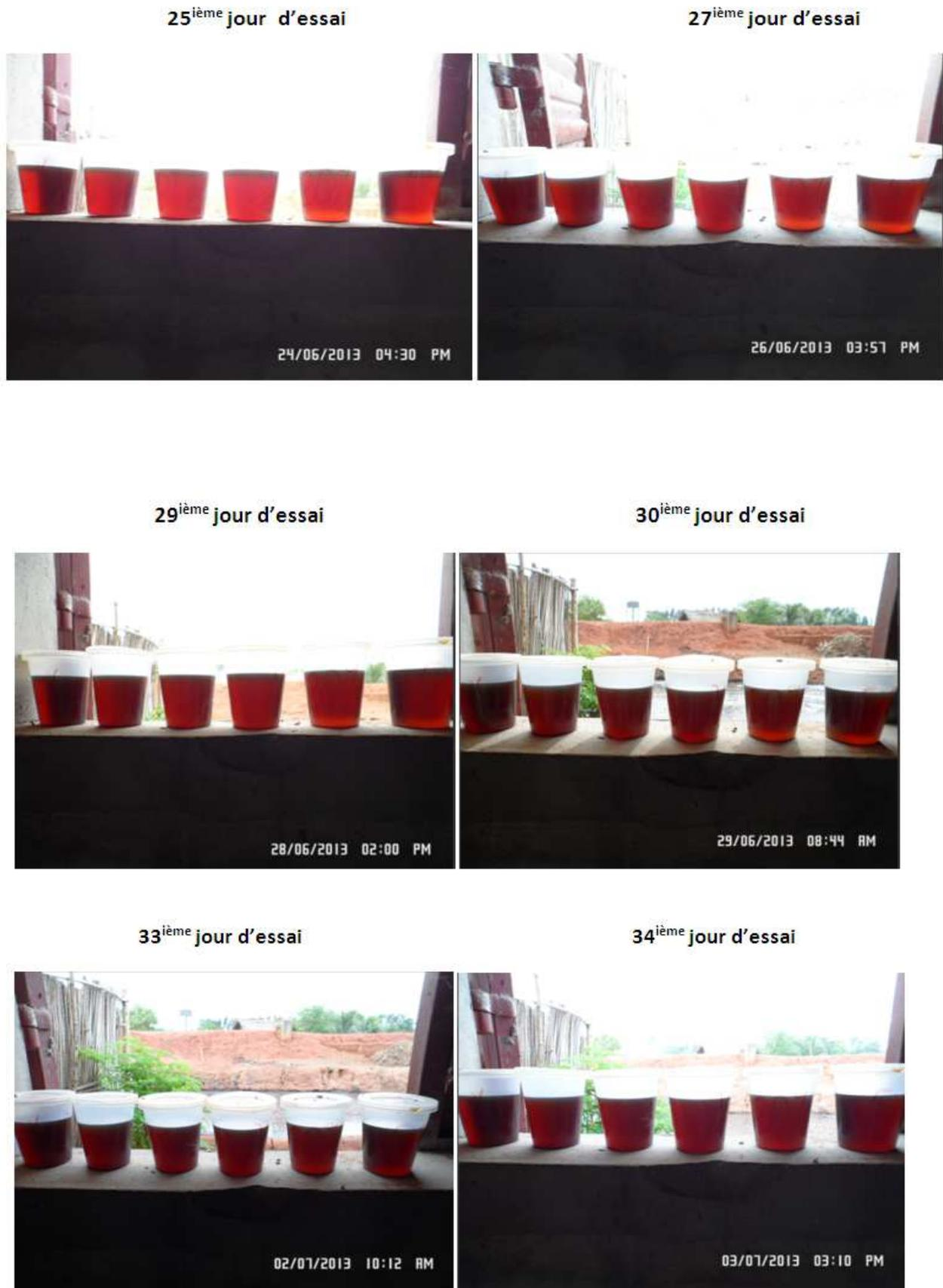
Figure 2-19 : Test de décantation ; source Auteur (Benin 2013)
