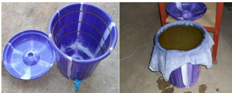
*Figure 2-7 : Photo montrant le seau en plastique avec les 3 niveaux de filtration (à gauche) et le seau avec les cerceaux entourés du tissu filtrant (à droite) lors de la filtration*
