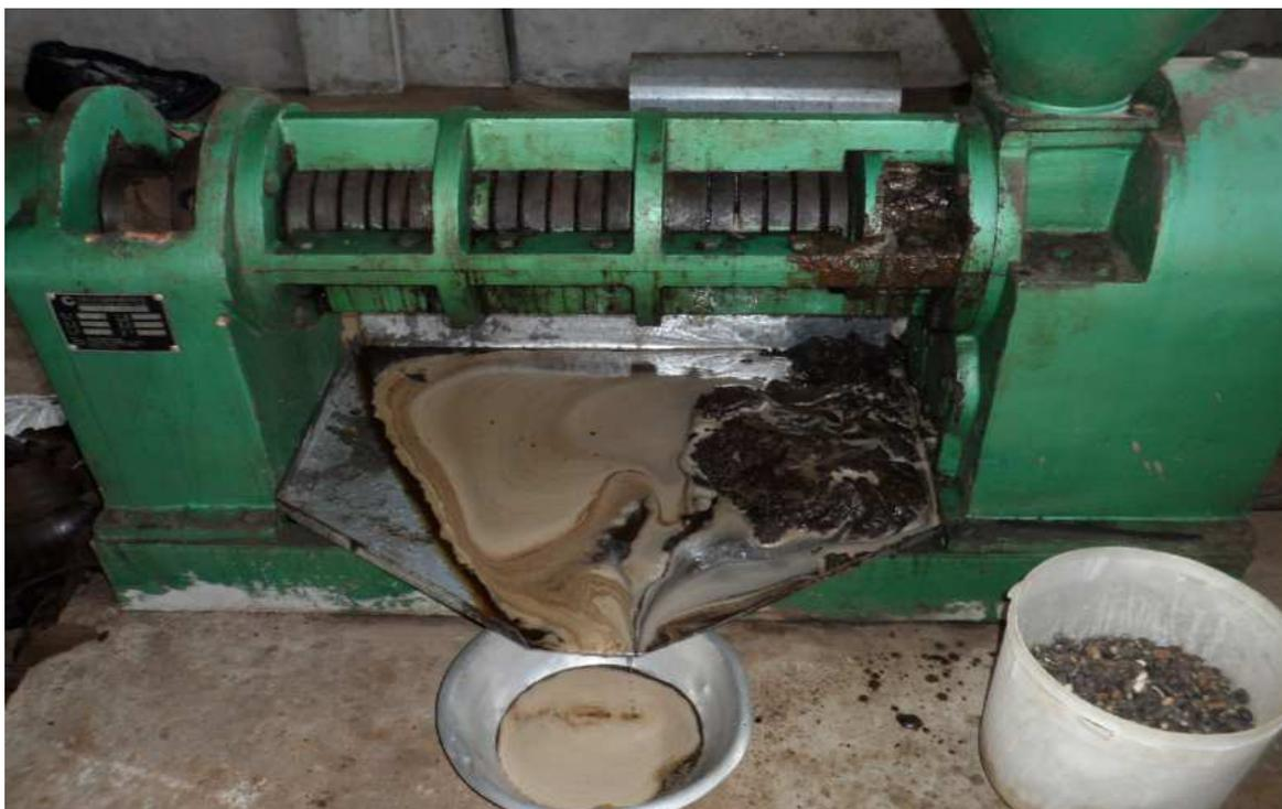
*Figure 2-6 : Presse à barreaux utilisée pour l'extraction d'huile de Jatropha*
