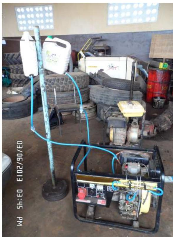
Figure 2-14 : Moteur adapté à la bicarburation
