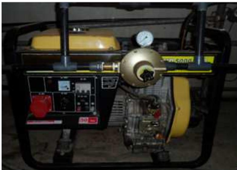
*Figure 2-9 : Générateur diesel, modèle HHD5000LH3, marque JINAODA avec une puissance maximale de 5 kW*
