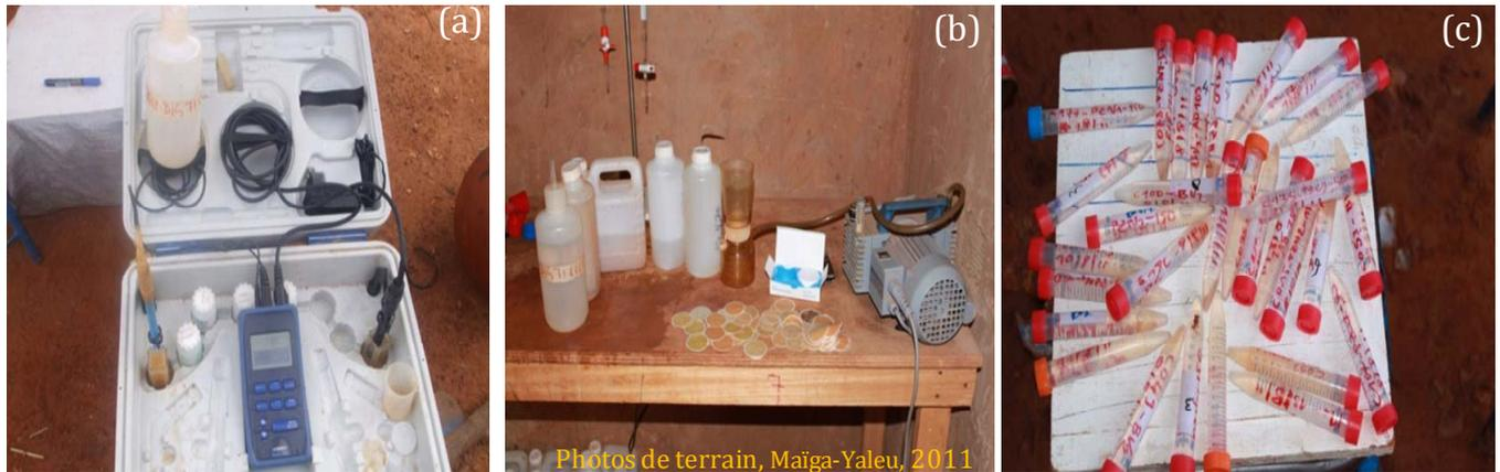
Figure 3.6 : (a) Logistique de mesures in situ de la température (T), du pH et de la conductivité électrique (CE) avec un multi paramètre de terrain ; (b) Filtration à 0,45 µm avec le papier Whatman ; (c) échantillon 10 ml+1 ml de  $\text{HNO}_3$  concentré.
