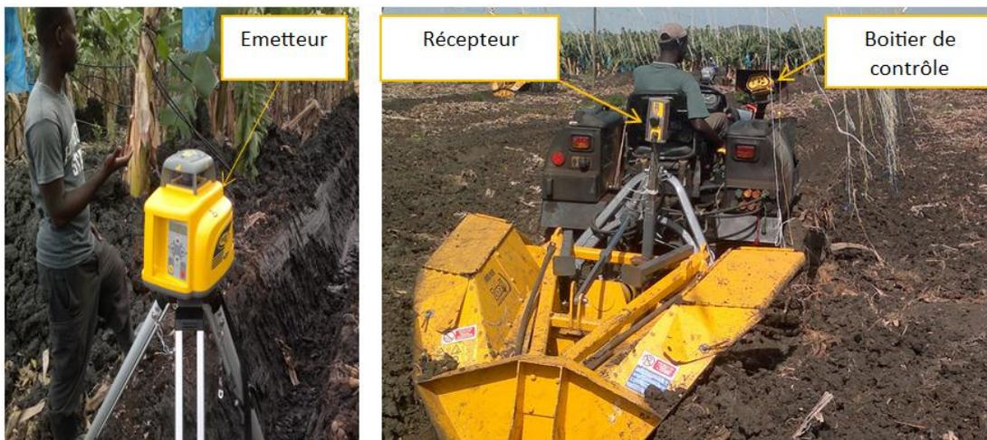
Figure VII : Les éléments du système laser
