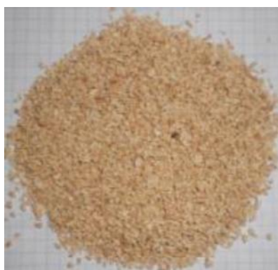
Figure 7 : Coques de Balanites aegyptiaca broyés et tamisés
