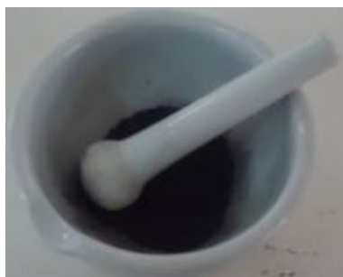
Figure 11 : Broyage du charbon avec le mortier en porcelaine
