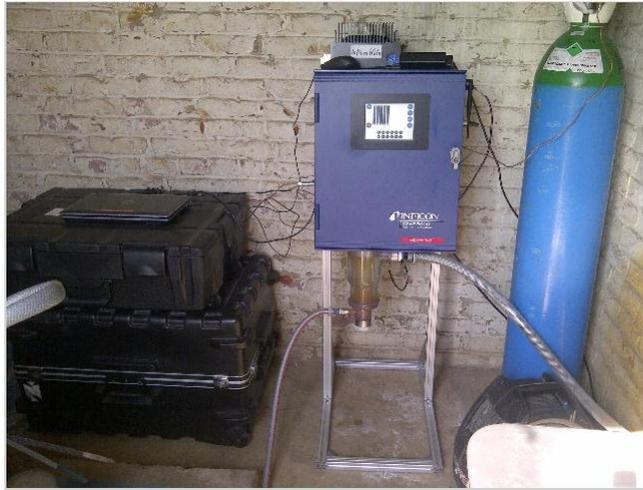
Figure 5 : CMS 5000 installé sur site
