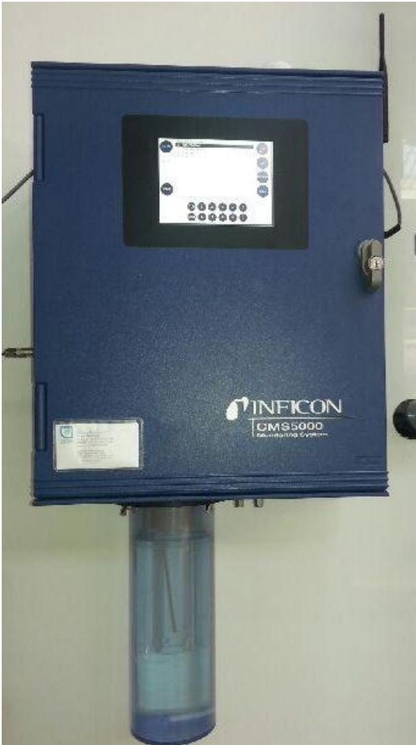
*Figure 1: CMS 5000 muni du récipient servant aux tests en statique*
