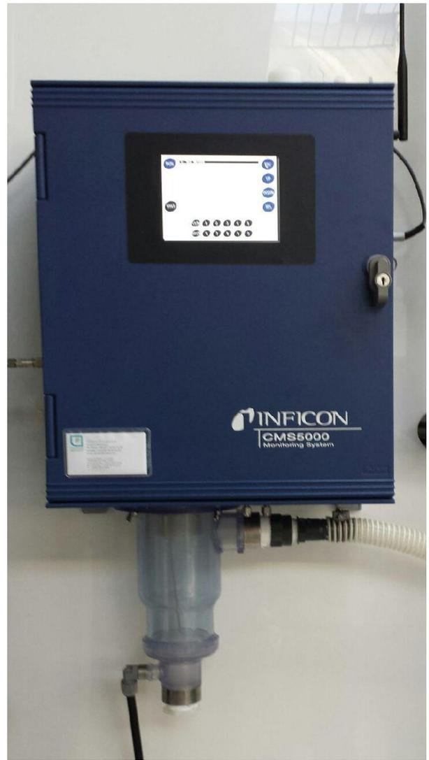
*Figure 2: CMS 5000 muni du récipient servant aux tests en ligne*
