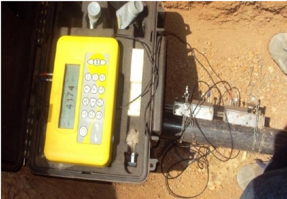
**Figure 4:** *enregistrement des débits de consommation d'une borne fontaine par le débitmètre ultrason de marque Micronics*
