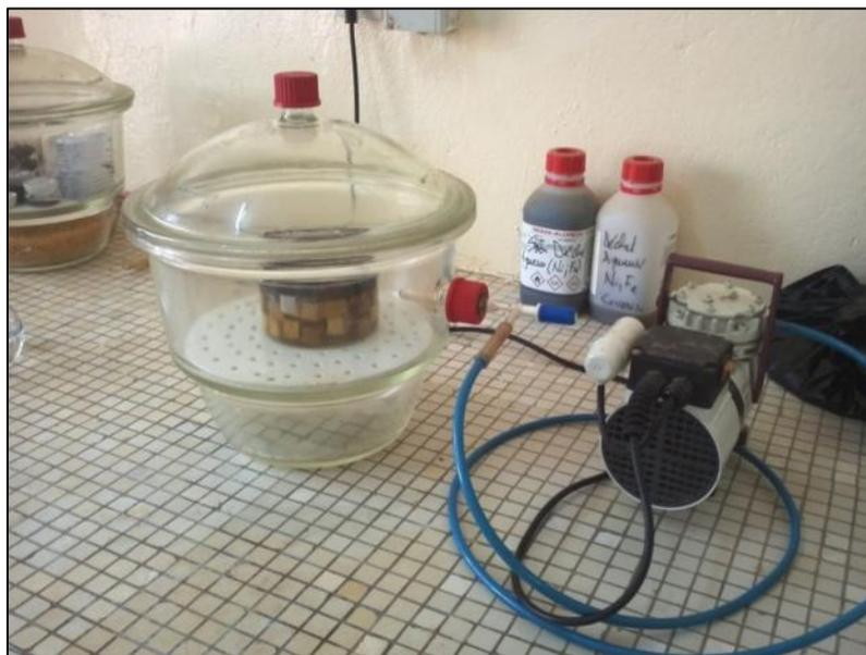
Figure 6 : Dispositif de l'imprégnation sous vide
