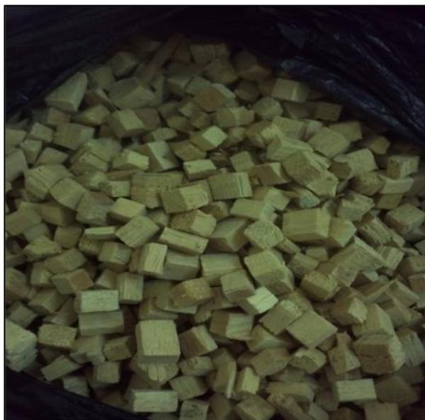
Figure 3 : Grains de bois Samba cubiques de 5mm après sciure
