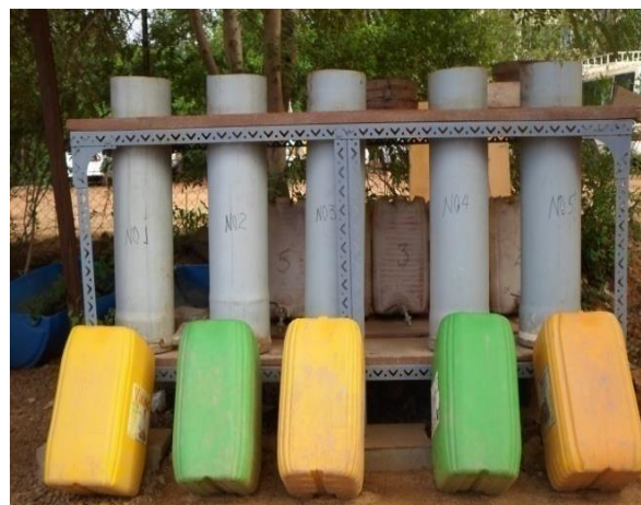
Figure 5 : Dispositif expérimental de vermifiltration
