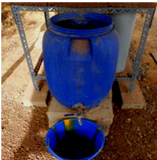
Figure 4 : Dispositif de prélèvement de l'eau grise
