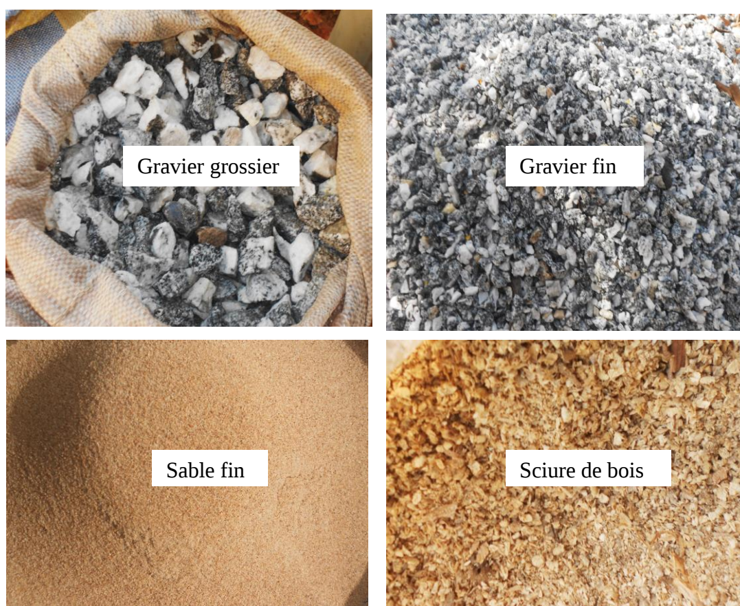
Figure 7 : Matériaux constitutifs des vermifiltres B2, B3 et B4
