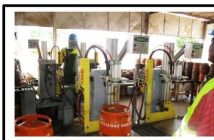
Figure 10: Emplissage de bouteilles
