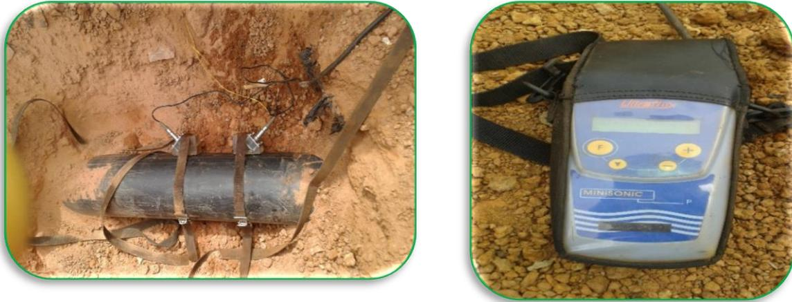
Figure 7 : Prise de débit à l'aide d'un débitmètre
