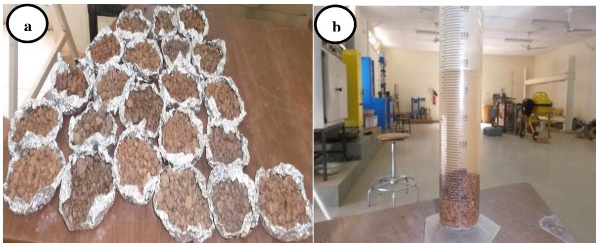
**Figure 8 :** Echantillons de gravier prêts pour l'étuve (a) et éprouvette graduée (b)
