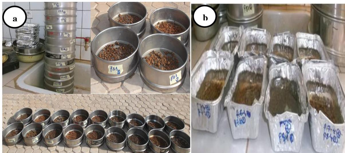
**Figure 9 :** Séchage d'échantillons de gravier au soleil dans les tamis (a) et échantillons de gravier immergés dans l'eau contenue dans les barquettes d'aluminium (b)
