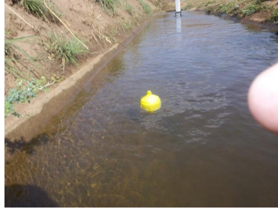
Jaugeage au flotteur (Mars 2013)
