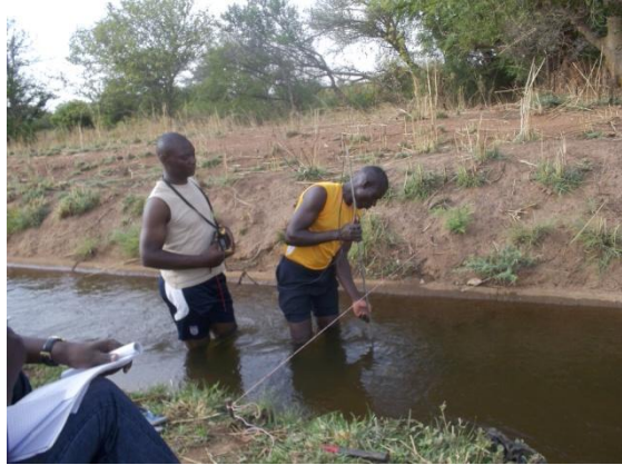
Jaugeage au micro-moulinet (Mars 2013)
