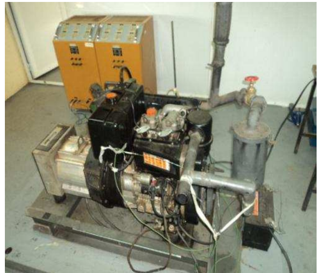
Figure 7 : vue d'ensemble du moteur avec le dispositif de la vanne d'EGR
