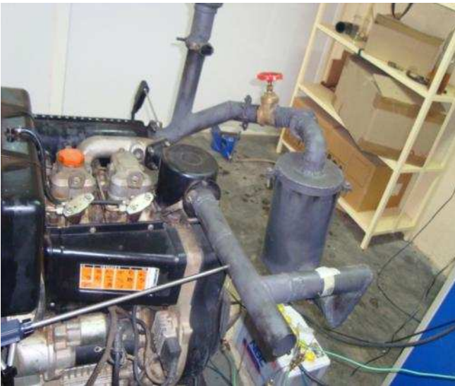
Figure 6 : vanne EGR montée sur le moteur
