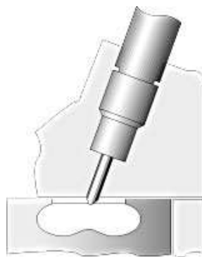
Figure A.8.2 : principe du moteur Diesel à injection directe
