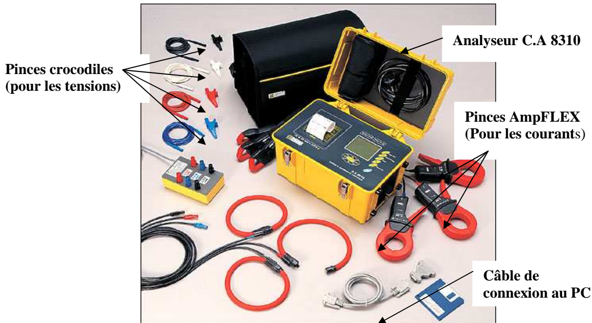
Figure III.2 : Analyseur de réseau C.A 8310 et connectiques de câblage au réseau et sur le PC [21]
