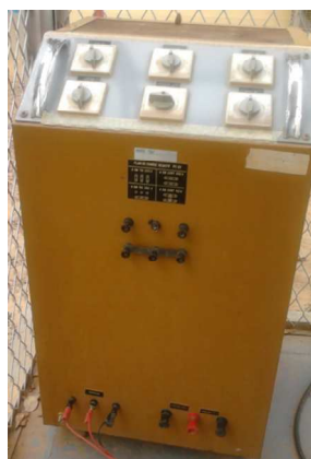
Figure II.1-6 : Bancs de charges résistives utilisés dans les tests
