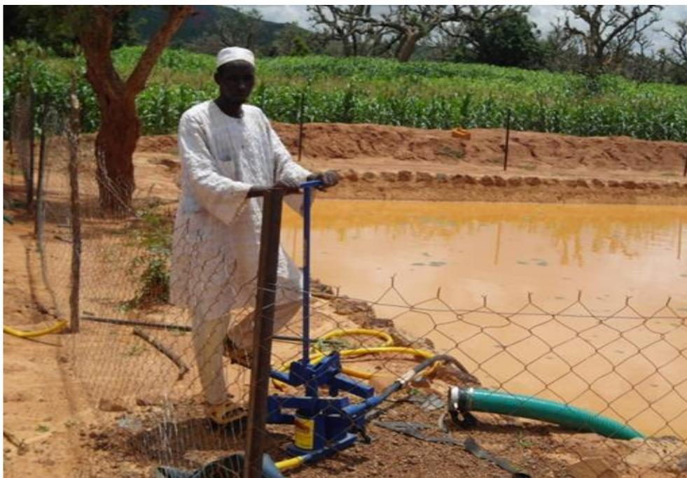
Photo 13. Pilotage de l'irrigation de complément à partir de la pompe à pédale dans le village de Mogodin en zone sahélienne
