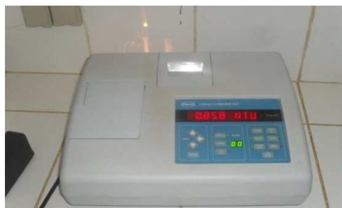
Figure 6 : turbidimètre
