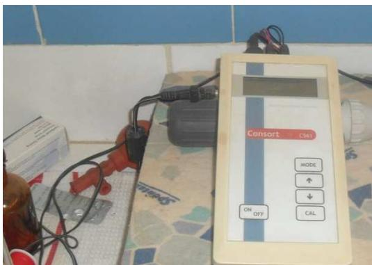
**Figure 8 : conductimètre**
