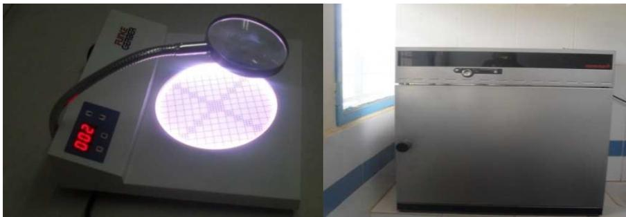
**Figure 12 : compteur de colonie    Figure 13 : incubateur à 44°C**
